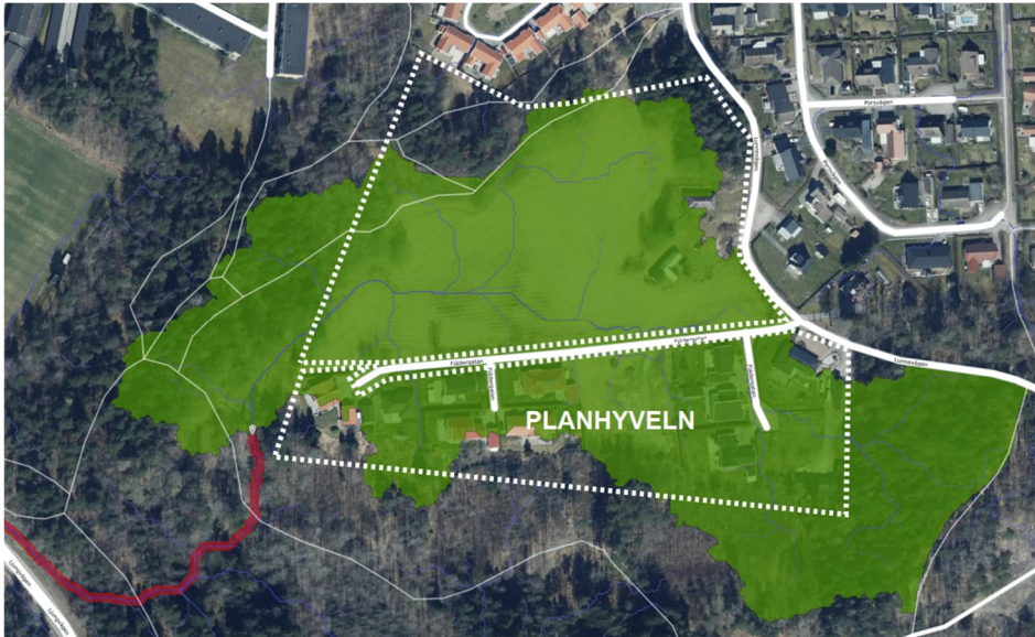
Figur 9 Avrinningsområde (grönt område + område inom vitstreckad linje) som planeras avledas till dammen (Scalgo Live, 2023), reviderad av Sweco.
