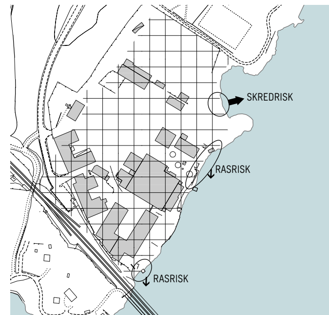
Bilden visar översiktligt var det finns ras- och skredrisk samt område som bedömts som mest förorenat/utfyllt med förorenade massor (skrafferat område).
