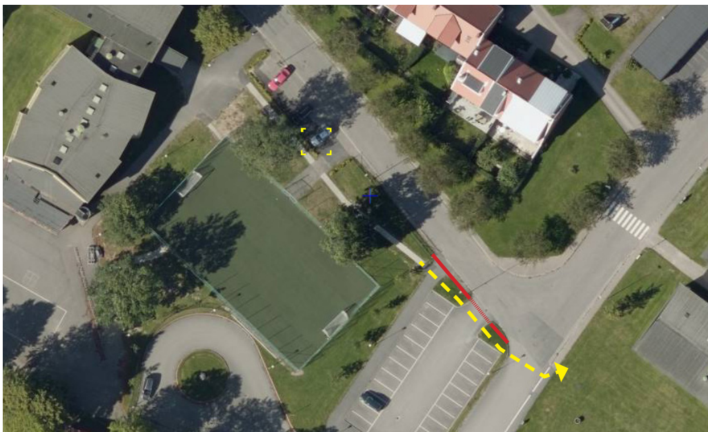
Förlängning staket (rött) och gångbana (gult).
